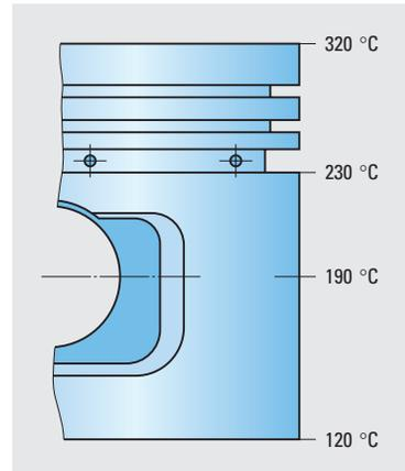
10. Tracez en rouge, à l'échelle 5 : 1, la forme du piston froid (20°C) de telle sorte que le diamètre du piston mesure exactement 90 mm à la température de service.
