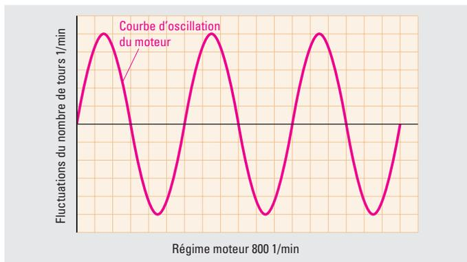
6. Dessinez la courbe d'oscillation de l'arbre à prise directe dans le diagramme dès que les fluctuations du nombre de tours de la boîte de vitesses se réduisent à 1/5e de celles du moteur.
