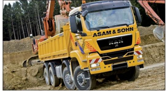
Illustration 2 : Véhicule de chantier avec concept d'entraînement 8x8/4
